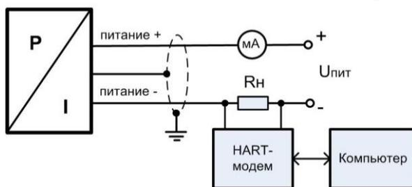
**2-проводная линия (вых. сигнал – ток и HART)**
