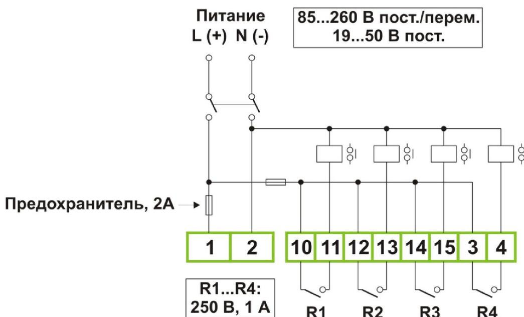
Рисунок 2.12. Пример включения реле (тип – “сухой контакт”).
