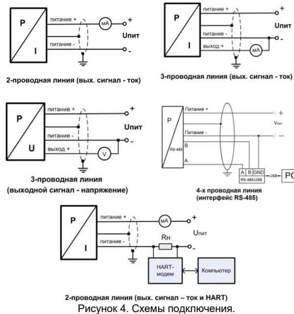
4.10. При подключении цепей необходимо соблюдать полярность. Датчики имеют защиту от короткого замыкания, обратной полярности и обрыва – не повреждаются, но и не работают.
