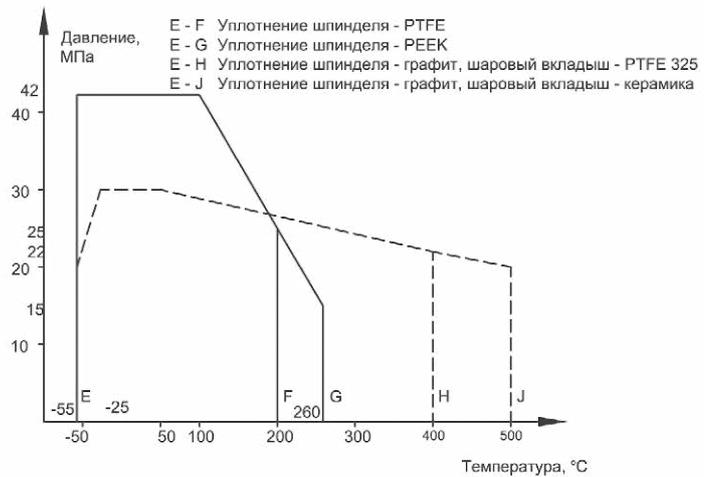
Максимальные значения температуры и давления среды в зависимости от материала уплотнения шпинделя и шарового вкладыша.
