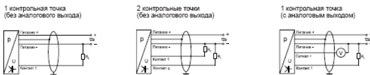
Рисунок В.1. Схема внешних электрических соединений датчика DS 4.
