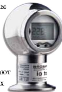
измерений абсолютного, избыточного и вакуумметрического давлений в диапазоне от 0...0,16 до 0...10 бар, механическими присоединениями DIN 11851 (молочная гайка), VARIVENT® или Clamp. Основная погрешность 0,2 ДИ.
