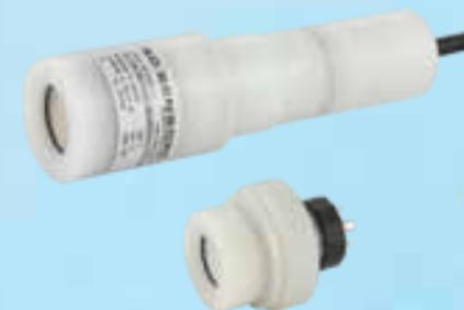
раствора гипохлорита натрия), морской воды. Например, погружной датчик уровня BD Sensors RUS LMK 858 с керамической мембраной, корпусом из PVDF, уплотнением из EPDM и кабелем с тефлоновым покрытием гарантированно «держит» серную кислоту (H2SO4) концентрацией от 5 до 98 % и температурой до 50 С.
