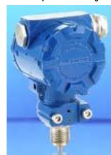
**Датчики серии HMP 331** – это высокоточные датчики избыточного/абсолютного давления в полевом корпусе с HART-протоколом. Основная погрешность 0.1%ВПИ. Масштаб перенастройки диапазона 1:10, смещение нулевого значения от 0 до 90%ВПИ. Имеется ис-
