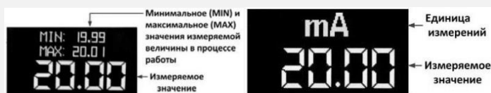
Рисунок В. Переключаемые экраны прибора, отображающие измеряемое значение
