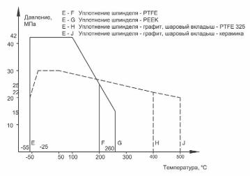
Максимальные значения температуры и давления среды в зависимости от материала уплотнения шпинделя и шарового вкладыша.
