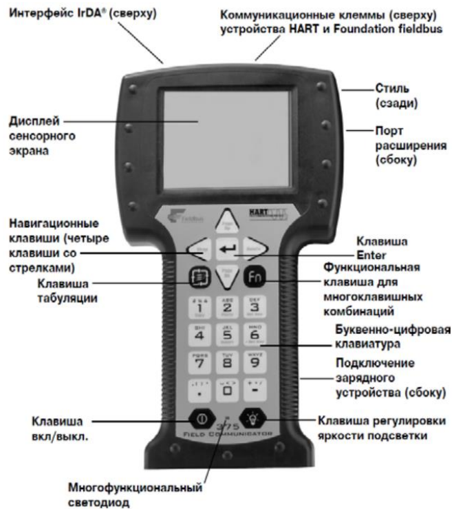
Рисунок D. Назначение элементов управления коммуникатора модели 375
