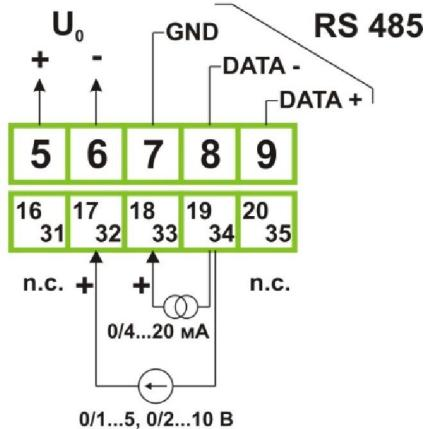
**Рисунок 2.6. Обозначение контактов (тип реле – “сухой контакт”, исполнение без активного токового выходного сигнала).**
