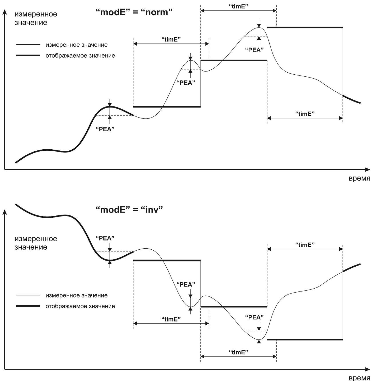
Рисунок 3.2. Логика работы детектора экстремальных значений. Вверху – отображение пиков, внизу – отображение впадин.
