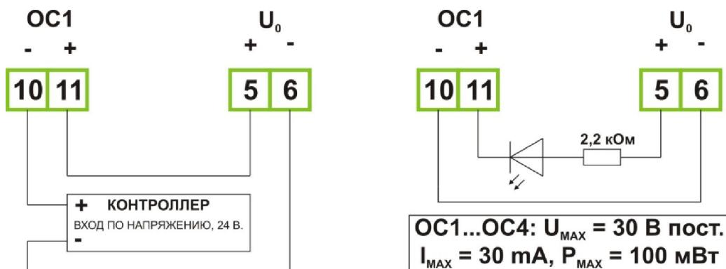
Рисунок 2.14. Примеры включения реле (тип – “открытый коллектор”).
