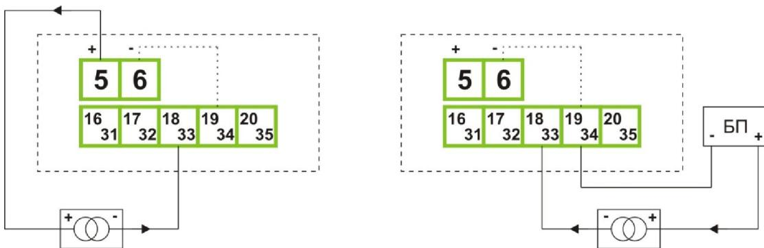
Рисунок 2.9. Схемы включения преобразователя 4...20 мА / 2-х пров.
