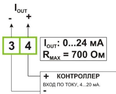
Рисунок 2.15. Пример включения активного токового входного сигнала.
