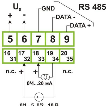
**Рисунок 2.7. Обозначение контактов (тип реле – “сухой контакт”, исполнение с активным токовым выходным сигналом).**
