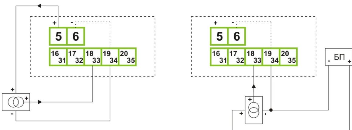
Рисунок 2.10. Схемы включения преобразователя 0/4...20 мА / 3-х пров.
