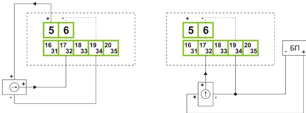
**Рисунок 2.11. Схемы включения преобразователя 0/1...5, 0/2...10 В / 3-х пров.**
