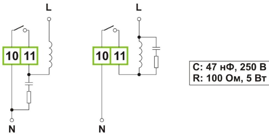
Рисунок 2.13. Пример включения RC-цепи для искрогашения.
