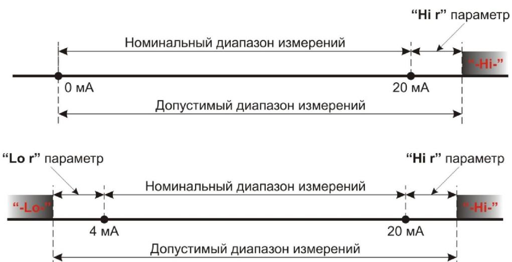
Рисунок 3.1. Определение номинального и допустимого диапазона измерений.
