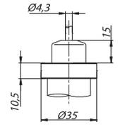
Кабельный ввод без трубки компенсации атмосферного давления
