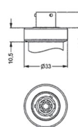
разъём MIL / Bendix (тип PT 02 A 10-6 P)
